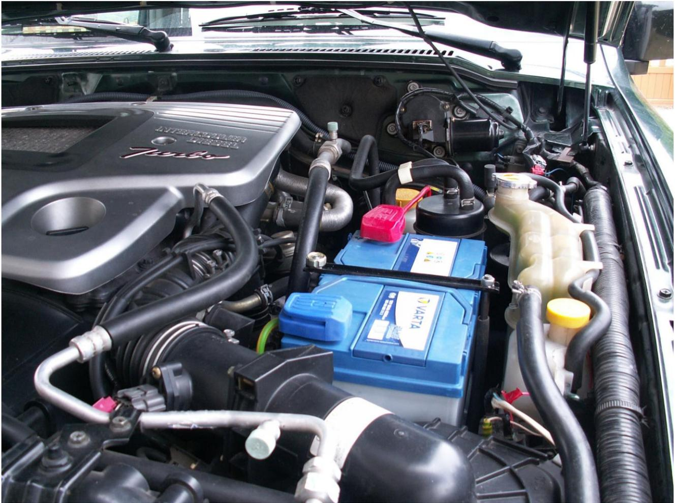
Reste à installer un coupleur de batterie : un emplacement est libre face aux électrovannes du blocage AR (sur un BVA l'assistance d'embrayage n'existe pas)
