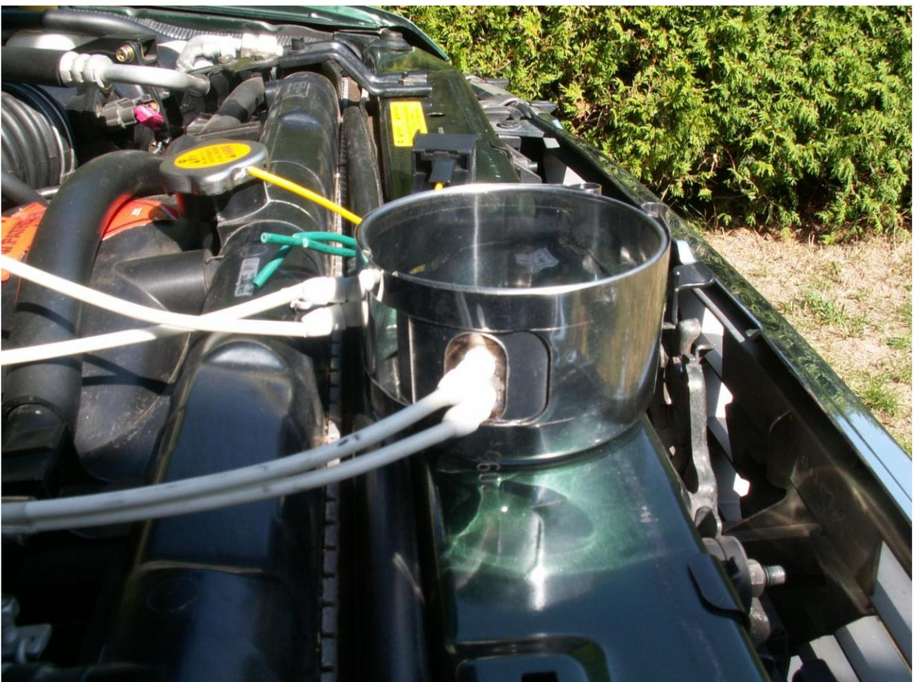
Avant d'installer le tout j'ai effectué un test de fonctionnement à blanc. J'ai aussi réfléchi aux connexions possibles des résistances : soit les deux de 150 watts en série ou en parallèle.
