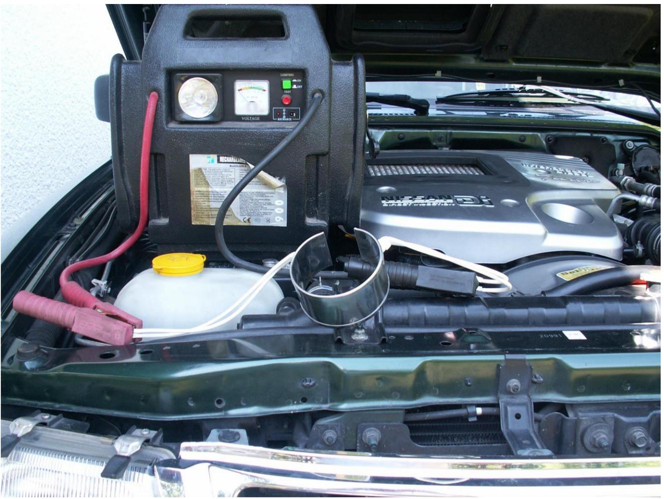
Le RACOR et sa poire (bien utile) tel qu'il est installé sur le 3.0
