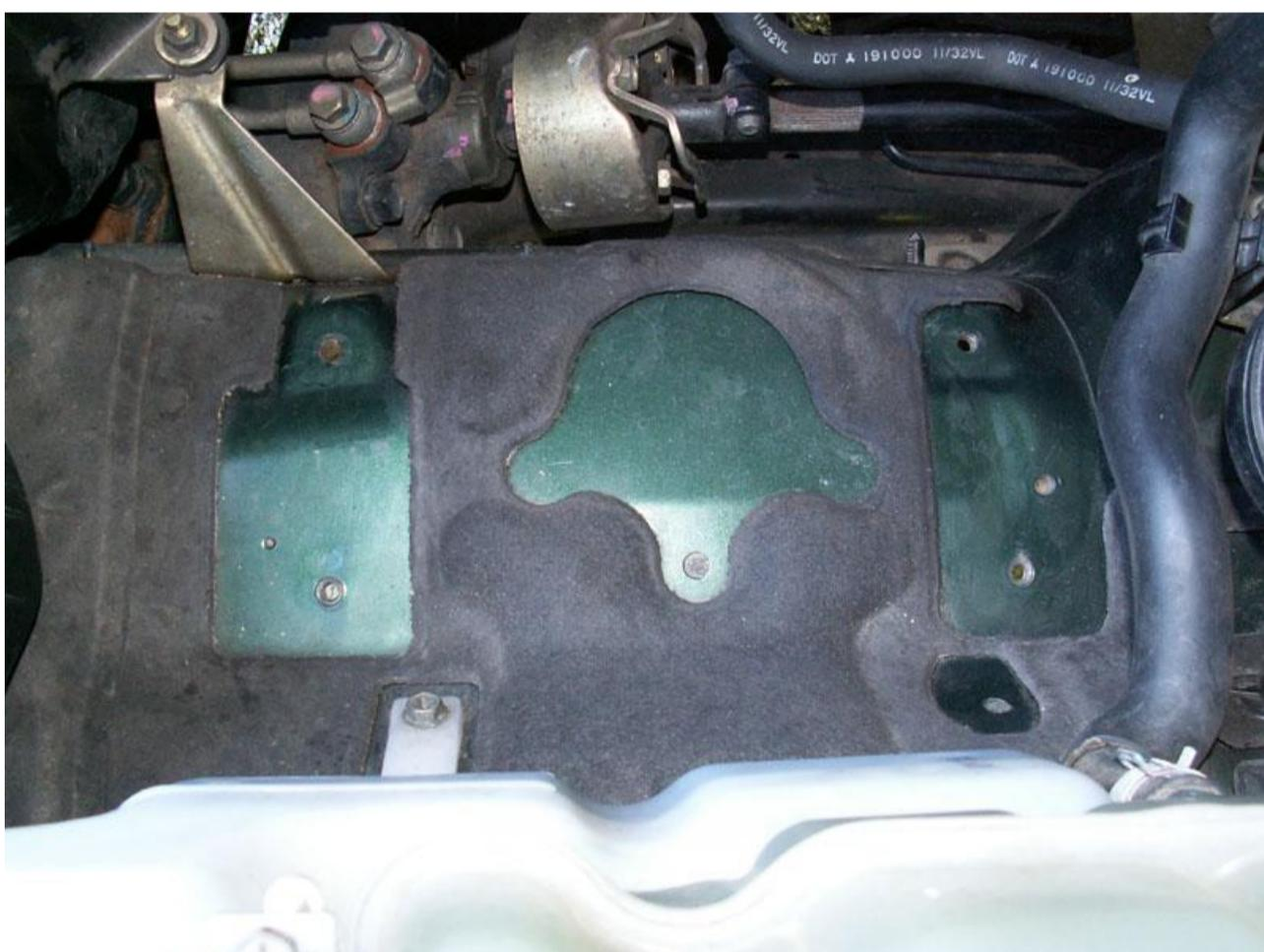
Au cours de l'été la batterie ayant subi un coup de chaud (décharge spontanée au point de n'allumer que faiblement les voyants) la question s'est posée d'équiper le troll d'une batterie auxiliaire d'autant qu'avec la boîte auto seul le démarreur peut lancer le moteur. Une platine de fabrication locale a donc été mise en place.
