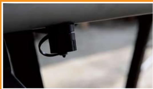
**4** Pour le passage des câbles le choix s'est porté sur un transit par le schnorkel, des prises étanches ont été installées à l'extrémité du schnorkel et sur la galerie. Un détail peut-être, mais qui assure une étanchéité quasi parfaite et un démontage facile car la galerie n'est installée que pour les sorties TT et Raid. Pour raccorder les fils nous avons choisi de les souder afin d'éviter des faux contacts et l'oxydation des cosses.
